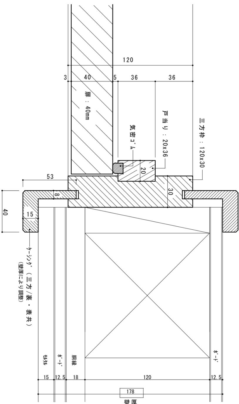
\* 壁厚・ケーシングは一例です。現場に合わせてケーシングで調整します。
