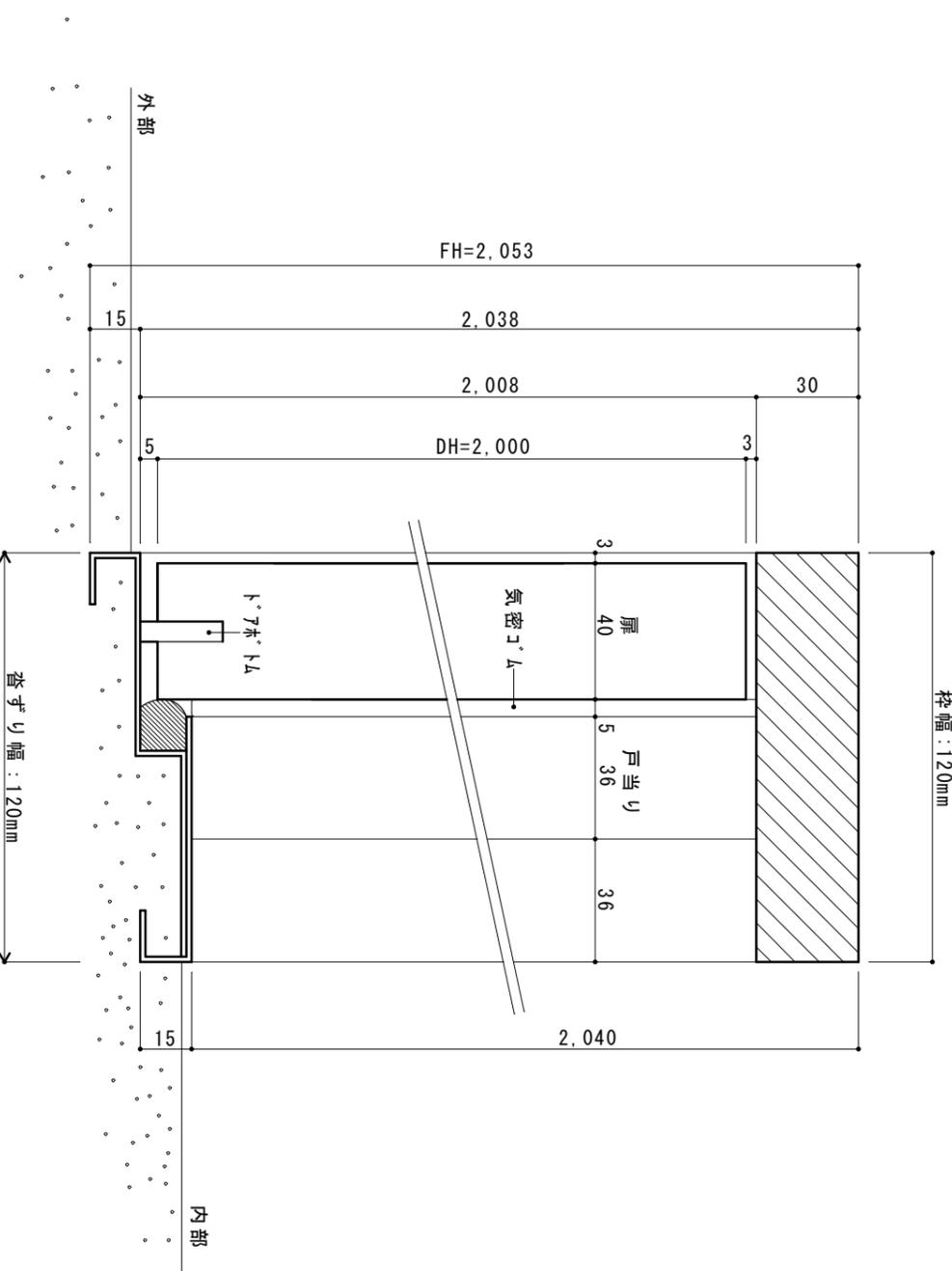
\* 枠を段差分欠込み、枠下端より沓すりを止める
